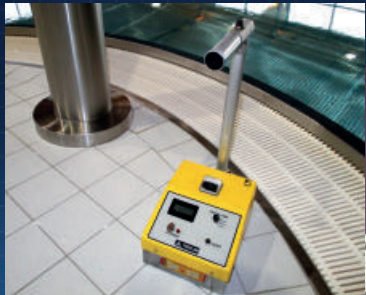
Einsatz einer Troxler-Neutronensonde
